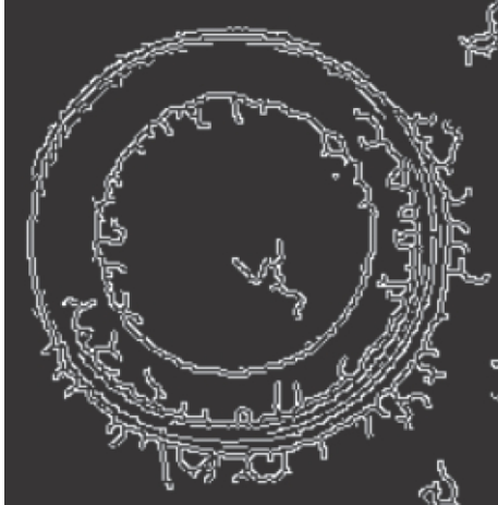
图 10 圆形阶跃型积冰样件边缘检测结果
