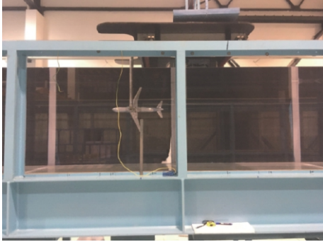
图5 模型安装于水洞中
