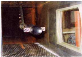
图1 栅格翼风洞实验模型 Fig.1 Wind tunnel test model of grid fins
