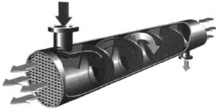
图 1 螺旋折流板换热器结构示意图 Fig. 1 Sketch of heat exchanger with helical baffles
