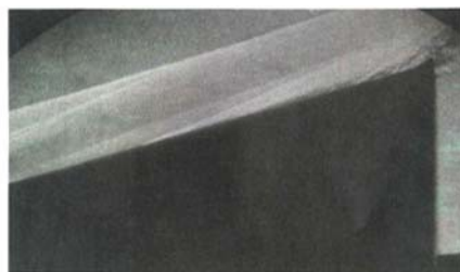
图9 在0.6m激波风洞上获得的某模型聚焦纹影图像 Fig.9 Focusing schlieren image of convexity model in the 0.6m wind tunnel
