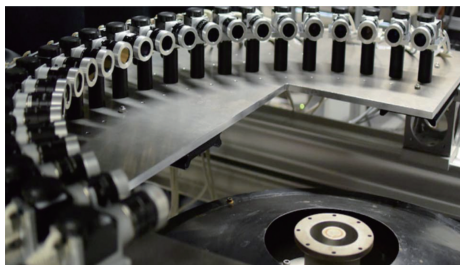
图4 多相机实验装置图 [43]
