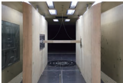
图 1 悬挂于风洞中的同步测力测振节段模型
